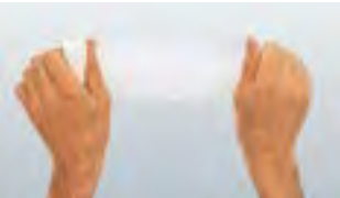
Die Krepppapierbinde lässt sich auf mindestens 200 % ihrer ursprünglichen Länge dehnen.
